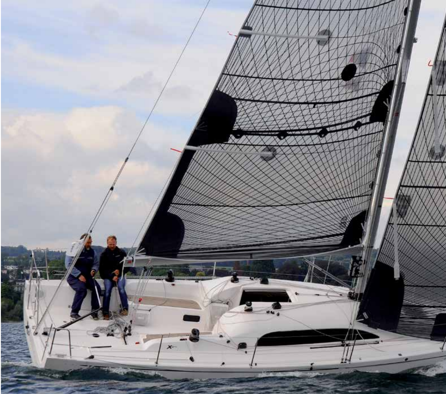
Perfekt gestaltetes Cockpit. Lediglich der straffe Relingsdraht im Rücken des Rudergängers stört etwas bei stärkerer Krängung. Die Fock lässt sich mittels Barberholer sehr eng schoten. Die Segel stehen ohne Tadel, sind passend zum Rigg praktisch reckfrei und erlauben aufgrund ihrer Geometrie einfaches Segeln mit wenig A
