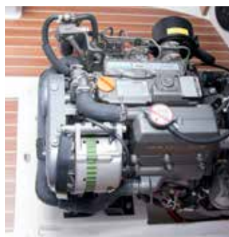
Wartungsfreundlicher geht's nicht. Nach dem Entfernen der Niedergangstreppe steht der Motor frei im Raum.
