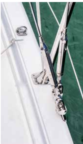
Die Püttings sind ganz außen angeschlagen, was die Stauchkräfte auf den Mast minimiert.
