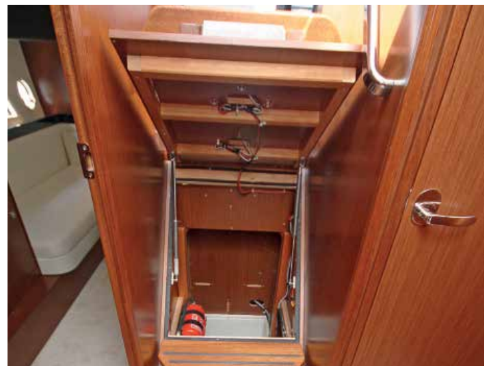
Das Vorschiff ist ausgebaut und als Stauraum nutzbar. An Backbord kann Niedergang ins Vorschiff, darunter Stauraum.
