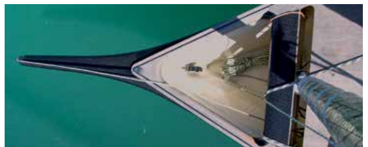
Rüssel und Gennaker-Trompete. Die Trommel der Genua sitzt auf einer Schiene und verschiebt sich samt Vorstag unter Druck nach Lee.
