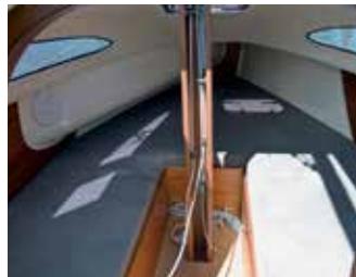
Unter den Polstern ist Stauraum, in der Maststütze laufen Groß- und Gennakerfall.
