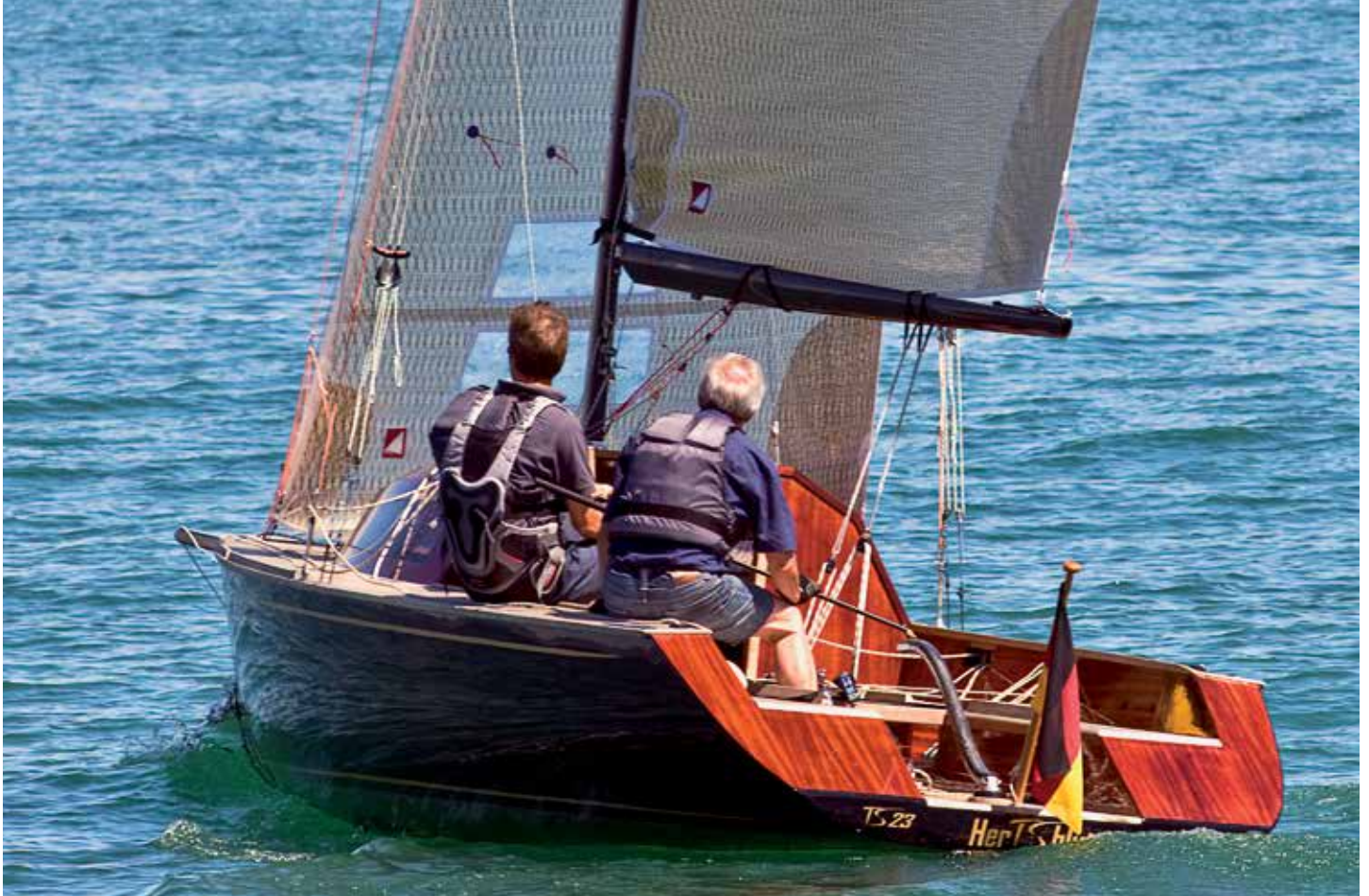
Wirkt wie Holz, ist aber GFK, das mit Holzfurnier überzogen wurde.
