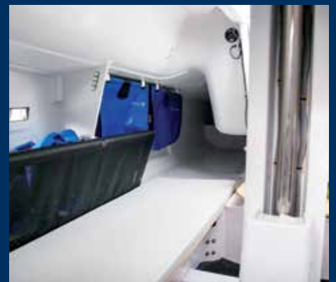
Blick vom „Nassraum“ an Kielkasten und Maststütze vorbei in die Hundekoje an Steuerbord. Die mit Netzmaterial bespannte Rohrkonstruktion ist Handlauf und Schwalbennest in einem. Dahinter zwei der insgesamt sechs Stautaschen, die im Cruisingpaket enthalten sind. Am Wantknie ist der einlaminierete Zapfen für die Rellingstütze deutlich zu erkennen. Das ist eine äußerst solide Konstruktion, denn bevor Zapfen oder Rumpf beschädigt werden, bricht die Stütze.
