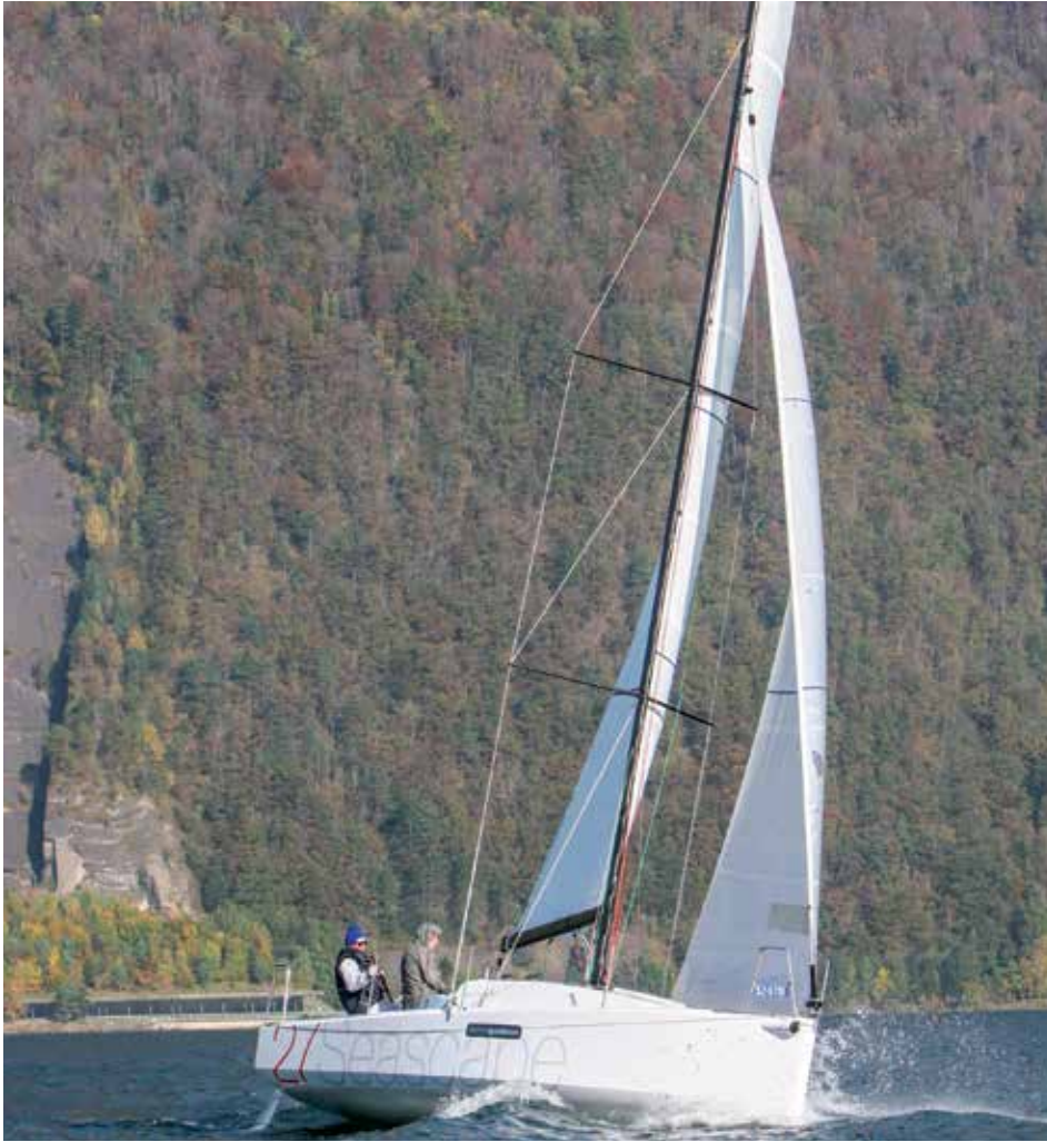
Das moderne Rigg mit Squarehead-Groß und nur gering überlappender Fock macht ordentlich Druck und lässt sich einfach handhaben.
