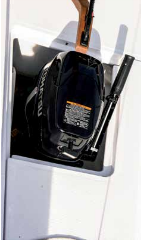
Motor in Fahrposition. Das entsprechende Segment aus dem Schachtdeckel wurde entfernt.
