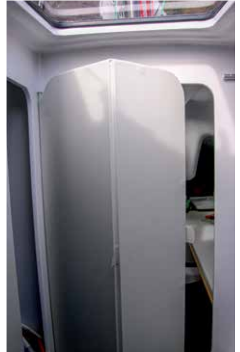
Zwei Falлтüren trennen den Nassraum vom Vorschiff und Salon ab. Wahlweise können sie auch – zusammengeklappt – den WC-Raum verschließen. Magnetschnapper halten die Türen geschlossen.
