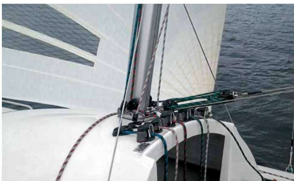
Die Delphia 24 OD ist mit vielen Trimmmöglichkeiten ausgestattet. Die Riggspannung lässt sich beim Segeln verstellen.
