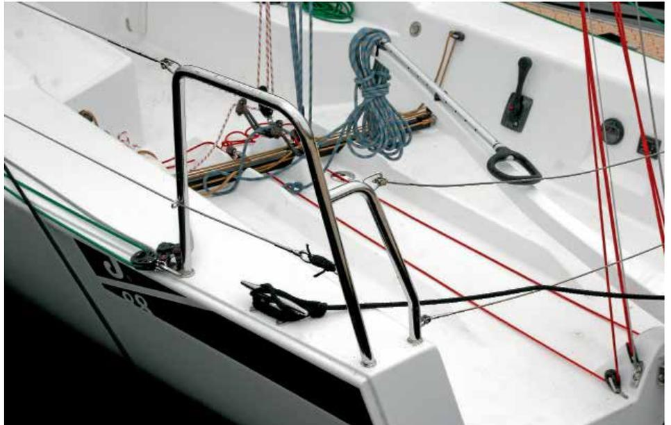
*Fußstützen sind in den Pflichtboden eingeformt. Der Traveller ist etwas erhöht, so dass er kein Wasser staut.*
