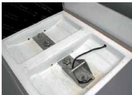
Heissauge zum problemlosen Kranen. Der Kiel ist zum Potenzialausgleich leitend mit dem Rigg verbunden.
