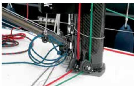
Kohlefasermast mit hochwertigen Beschlügen. Der Baum ist aus Aluminium.
