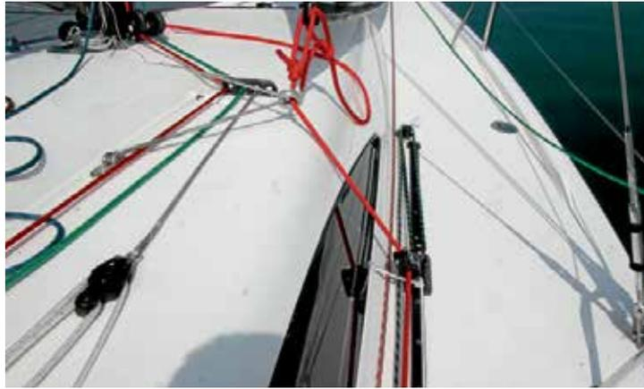
*Interessante Holepunktvariante: Der Barberholer für die Querverstellung wird jeweils von Luv aus über eine Vierfach-Talje bedient (graue Leine links). Die Längsverstellung erfolgt herkömmlich über Schiene und Rutscher mit Umlaufkugellager und dreifacher Untersetzung.*
