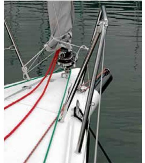
Die mittlere Stütze des Bugkorbs ist etwas nach innen aus der Flucht versetzt. Das gibt Stabilität und befreit das Deck von Biegekräften.
