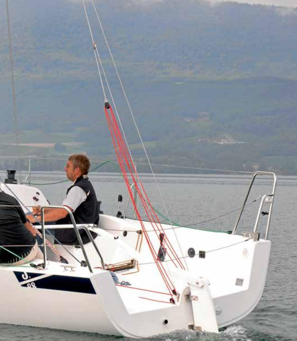
Das stark untersetzte Achterstag ist, zusammen mit dem über die gesamte Cockpitbreite reichenden Traveller, das Haupt-Trimminstrument des agilen Sportbootes.
