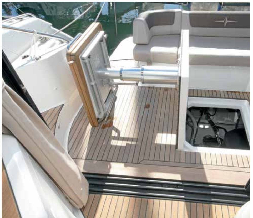
Zur Seite klappbare Tischeinheit, darunter Zugang zum Maschinenraum.
