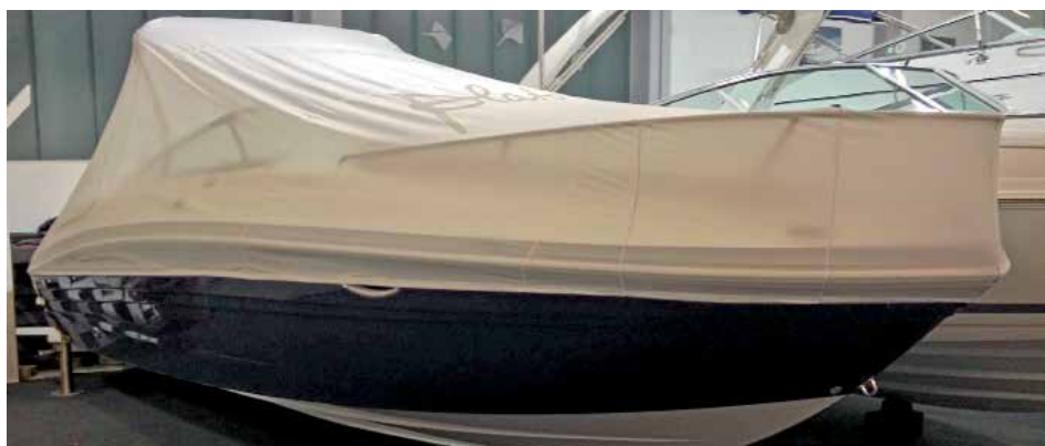
Die neuartige Persenning Plato ist extrem leicht, elastisch und wird wie eine Haut über das Boot gespannt.
