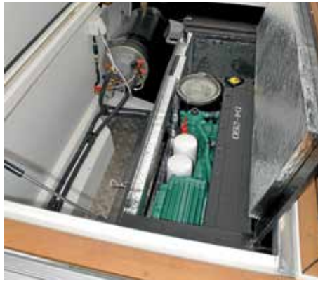
Der gekapselte Diesel.
