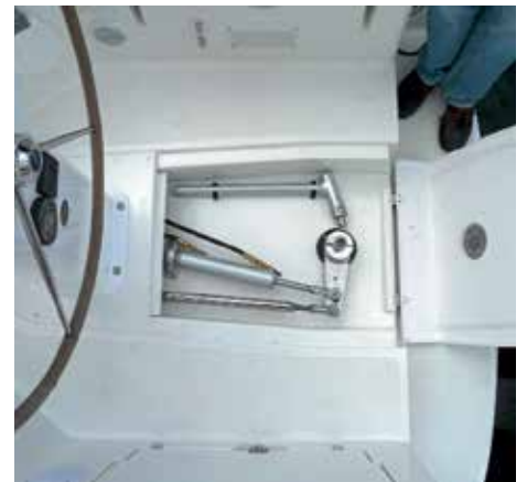
Eine gute Lösung: der Ruderquadrant mit Notpinne.
