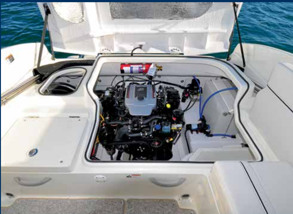
Augenweide für Technikfreaks, der sauber installierte MerCruiser 4.3 MPI, ECT/A1.
