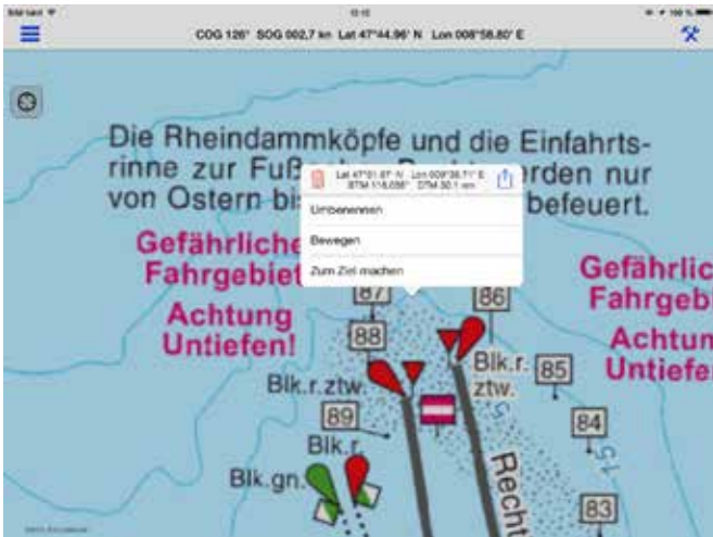
4. Dieser Name kann frei gewählt werden, indem das Symbol wieder mit einem Shorttouch angeclickt wird und im nun erscheinenden Fenster „Umbenennen“ gewählt wird. Jetzt kann ein beliebiger Name eingegeben werden.
