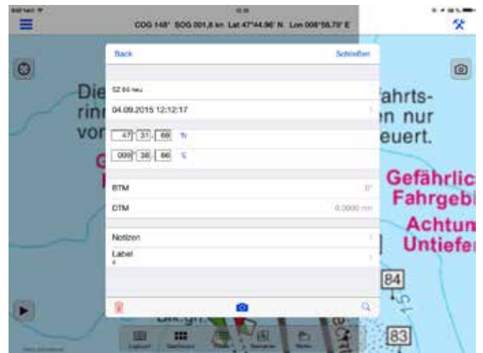
8. In diesem Fenster kann die exakte Position eingetragen werden, wobei die Zehntelminuten in zweistellige Werte gerundet werden müssen, was für die Praxis ausreichend genau ist.
