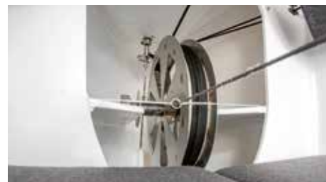
Mit einem Magic-Wheel wird das Ballast-Schwert angehoben.
