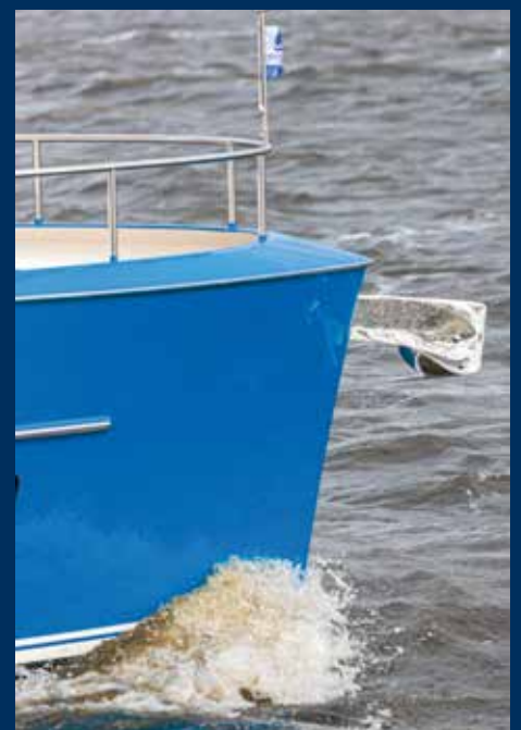
Der steile Vorderstevan schafft Platz unter Deck.
