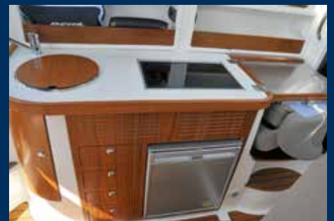
Die Pantry befindet sich in der Plicht. Der Kocher mit Ceranfeld ist dieselbetrieben.
