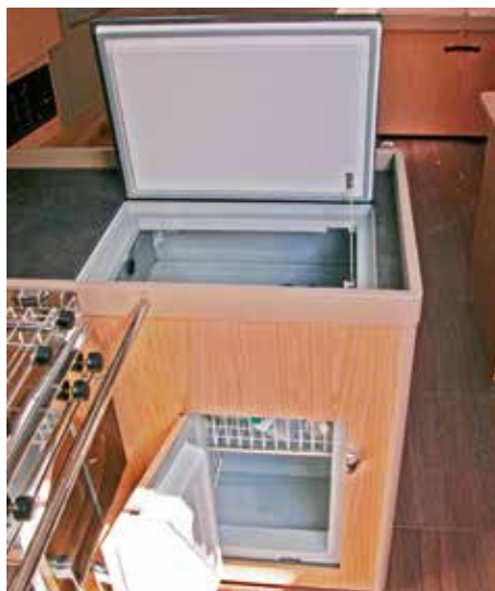
Aufwändige und praxiserichte Lösung: Die riesige Kühlbox kann von unten und oben bestückt werden.
