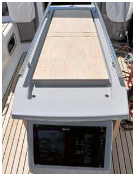
Cockpittisch mit Anzeige des Navigationssystems in der Stirnseite integriert.
