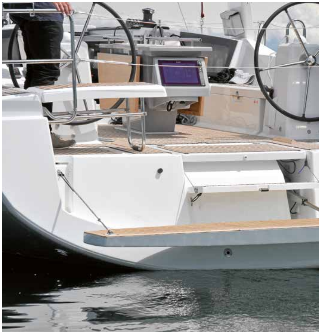
Die Heckplattform wird mit einem Linearantrieb elektrisch abgesenkt. Der Winkel der Halteleinen ist nicht ideal.
