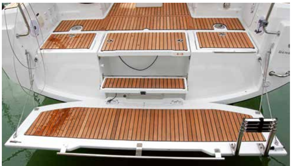
Abgeklappte Plattform mit Stufe und Heckleiter: Bequem zum Baden und bequem im Hafen. Hinter der klappbaren Stufe ist Platz für eine Rettungsinsel. Durch die Klappen daneben kommt man an die beiden Ruderquadranten.
