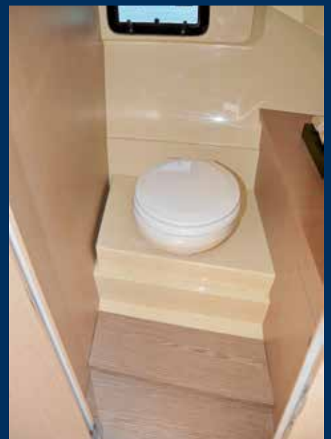
Die Nasszelle mit elektrischem Pump-WC, Spülbecken und einem Stauraum darunter.
