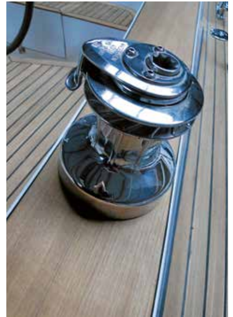
Gut platziert: Andersen-Winch 40 ST, two speed.
