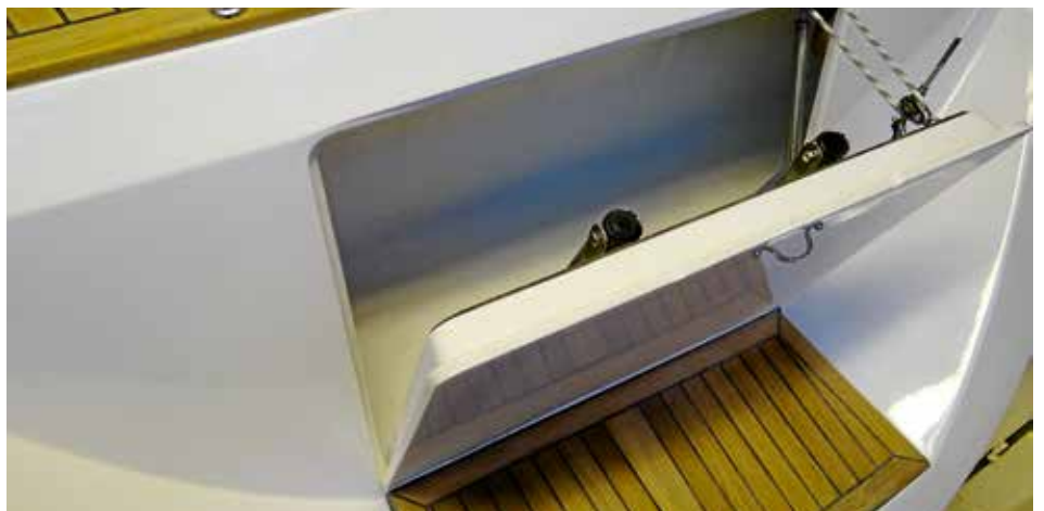
Pfiffige Lösung: klappbare Badeplattform mit versteckter Badeleiter.
