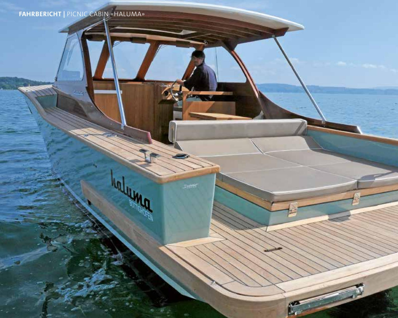
Das Hardtop schützt bei Sonne und Regen und kann bei Bedarf mit einer Persenning rundum geschlossen werden.
