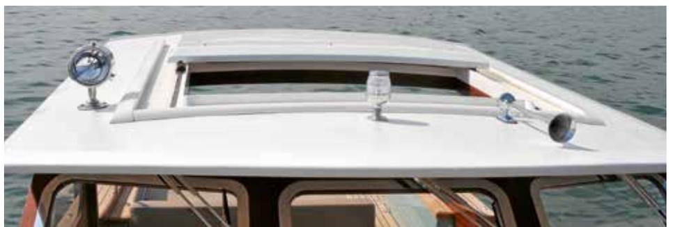
Ein Schiebedach bringt Frischluft in das Cockpit.
