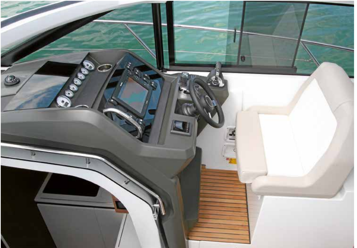
Analoganzeigen für die Motordaten, Plotter für die Navigation. Rechts neben dem Steuerrad ist der Joystick für die Steuerung der Z-Antriebe, verdeckt daneben die Bedieneinheiten für Bugstrahlruder und Trimmklappen.
