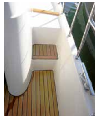
Teakbelegte Stufen auf die Seitendecks.
