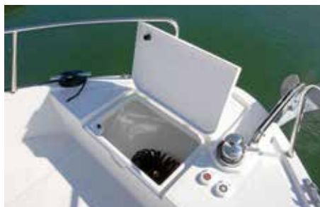
Ankerkasten mit versenkter, fußbedienbarer E-Winch.
