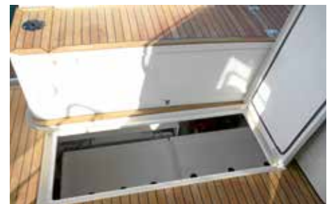
Stauraumzugang unter dem Cockpitboden.
