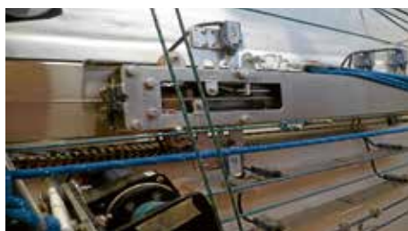
Gut zugängliche Mechanik unter Deck, durch die die Schwerkter gesteuert werden.
