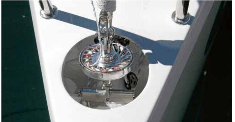
Aufwendige Konstruktion: Das Rohr für den Gennakerbaum verläuft mittschiffs. Dadurch kann dieser für den Code Zero auch nur teilweise ausgefahren werden und befindet sich trotzdem in der Mitte.
