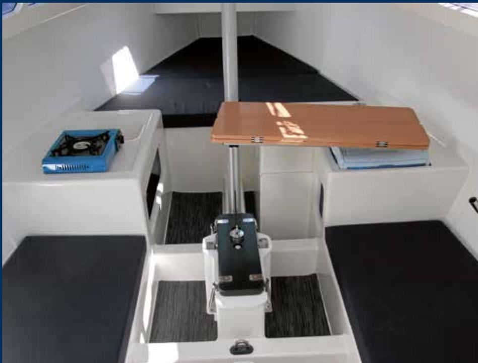
Alles vorhanden, was man für den Törn braucht. Auf der Backbordseite die Pantry mit Spüle und für Boote nicht zulässigem Gaskocher. An Steuerbord eine Kühlbox. Der drehbare Tisch passt auch in die Plicht. Im Vordergrund das Heißsauge.
