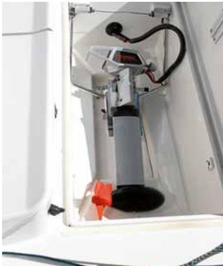
Im optionalen Motorschacht kann ein kleiner Außenborder oder, wie hier, ein Elektromotor eingebaut werden.
