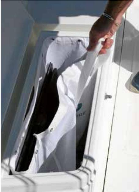
Interessante Lösung für das Steckschott: eine Tasche, die mit Druckknöpfen in der Backskiste befestigt wird.
