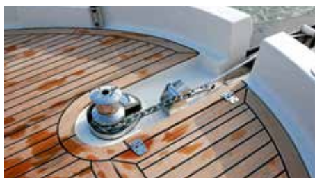
Ankerwinch mit Verholspill und Kettenstopper. Als Option ist eine Kettenwaschanlage erhältlich.
