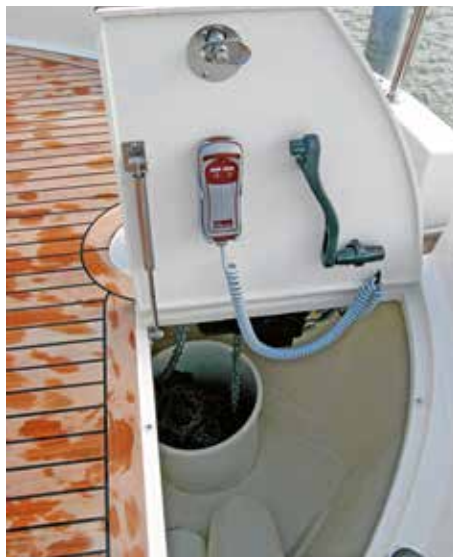
Die Kette fällt gleich in den Eimer, sodass der Ankerkasten auch noch für andere Dinge, beispielsweise Fender genutzt werden kann.
