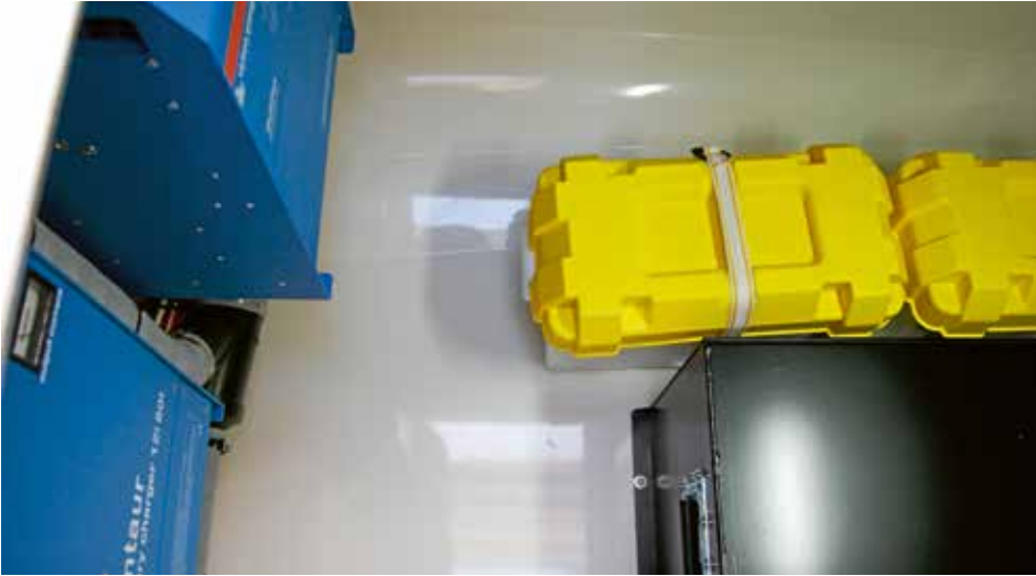
Energiezentrum: Unter dem Steuerstand sind die Batterien und die Ladetechnik untergebracht. In der schwarzen Kiste befinden sich die Fahrakkus. Die blauen Gehäuse enthalten Ladegerät und Wechselrichter.
