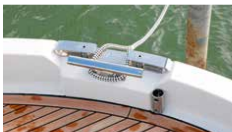
Die Klüsen enthalten Rollen. Damit ergibt das Verholspill erst tatsächlich einen Sinn.
