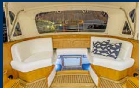
Zugang zur Unterflurkabine nach Entfernen des Cockpit-Sitzbank-Mittelteiles.
