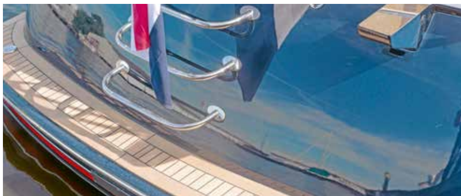
Aufgeschweißter Niedergang auf die Badeplattform.
