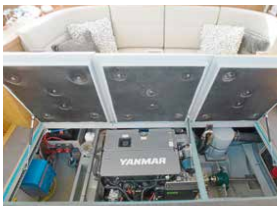
Servicefreundlicher Motorraum unter dem Salonboden.
