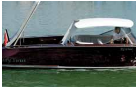
Die Lake Constance 760 gibt es mit einem Hardtop-Verdeck, das per Knopfdruck aus dem Motorraum ausgefahren werden kann. Die Kompositkonstruktion wiegt nur wenige Kilo und kann ganz geschlossen werden. Die Werft hat selbst an eine Einbuchtung für einen leichteren Ausstieg nach achtern gedacht.
