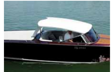
Die Lake Constance 760 gibt es mit einem Hardtop-Verdeck, das per Knopfdruck aus dem Motorraum ausgefahren werden kann. Die Kompositkonstruktion wiegt nur wenige Kilo und kann ganz geschlossen werden. Die Werft hat selbst an eine Einbuchtung für einen leichteren Ausstieg nach achtern gedacht.
