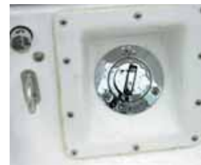
Bugspitze mit Tankeinfüllstutzen, Heißbringen und Entlüftung.
