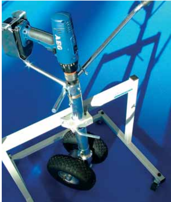
Bohrtrailern: Mit einem normalen Akkuschauber bestückt, präsentierte ETS auf der Interboot den kleinsten und leichtesten Trailerboy, der bis zu einer Tonne zieht.
