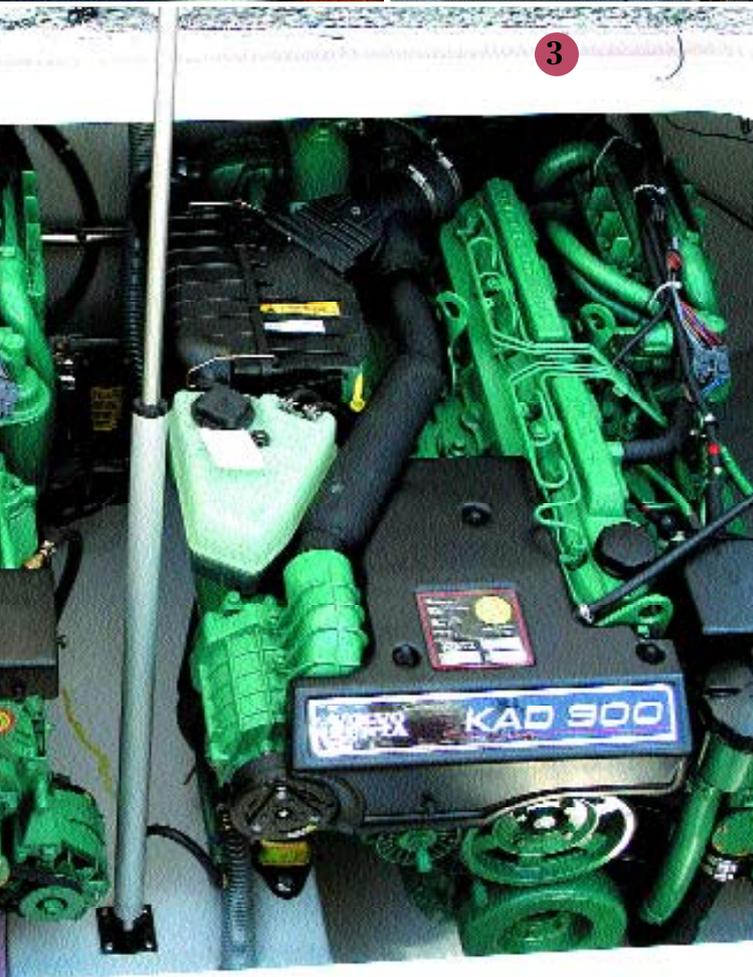
pressor und das Fünf-Tonnenboot jagt los, die Motoren sind jetzt bei höherer Drehzahl vom Turbolader zusätzlich unterstützt. Zwei Duoprops bringen die zweimal 210 kW / 285 PS ohne jegliche Kavitation ins Wasser. Für den Bodensee ist die Volvo-Penta-Doppelmotorisierung allerdings nicht zugelassen, hier muss man auf mit Kat ausgerüstete Benziner zurückgreifen.
