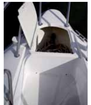
Der Durchstieg zum Bug mit dem Ankerkasten.
