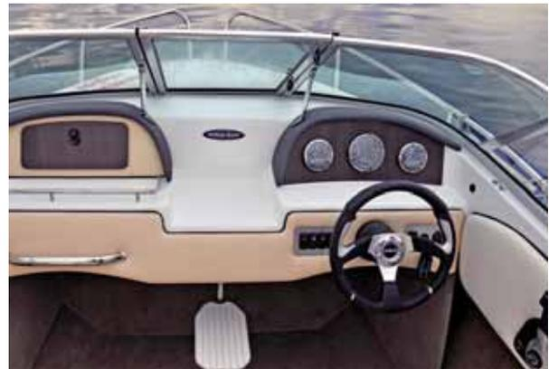
Übersichtliche Instrumentierung (Extra). Mit einem Tritt gelangt man durch die aufklappbare Scheibe aufs Vorschiff. Diese Smart-Craft Instrumente sind Extra.
