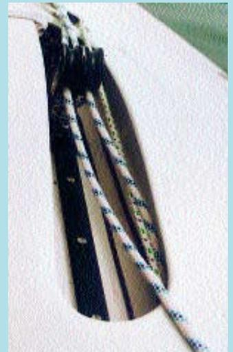
*Viele der Beschläge sind ins Deck eingelassen. So z. B. die Schiene mit dem Genuaholepunkt oder Niederholer und Achterstag. Letztere liegen gut platziert in Reichweite des Steuermanns.*
