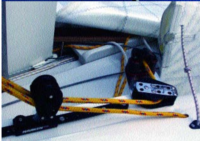
Unten links: die „Kommandozone“. Der Steuermann kann das Boot von hier aus praktisch einhand segeln, wenn seine Mitstreiter am Draht hängen. Die Großschot könnte allerdings noch eine Feinverstellung gebrauchen.
