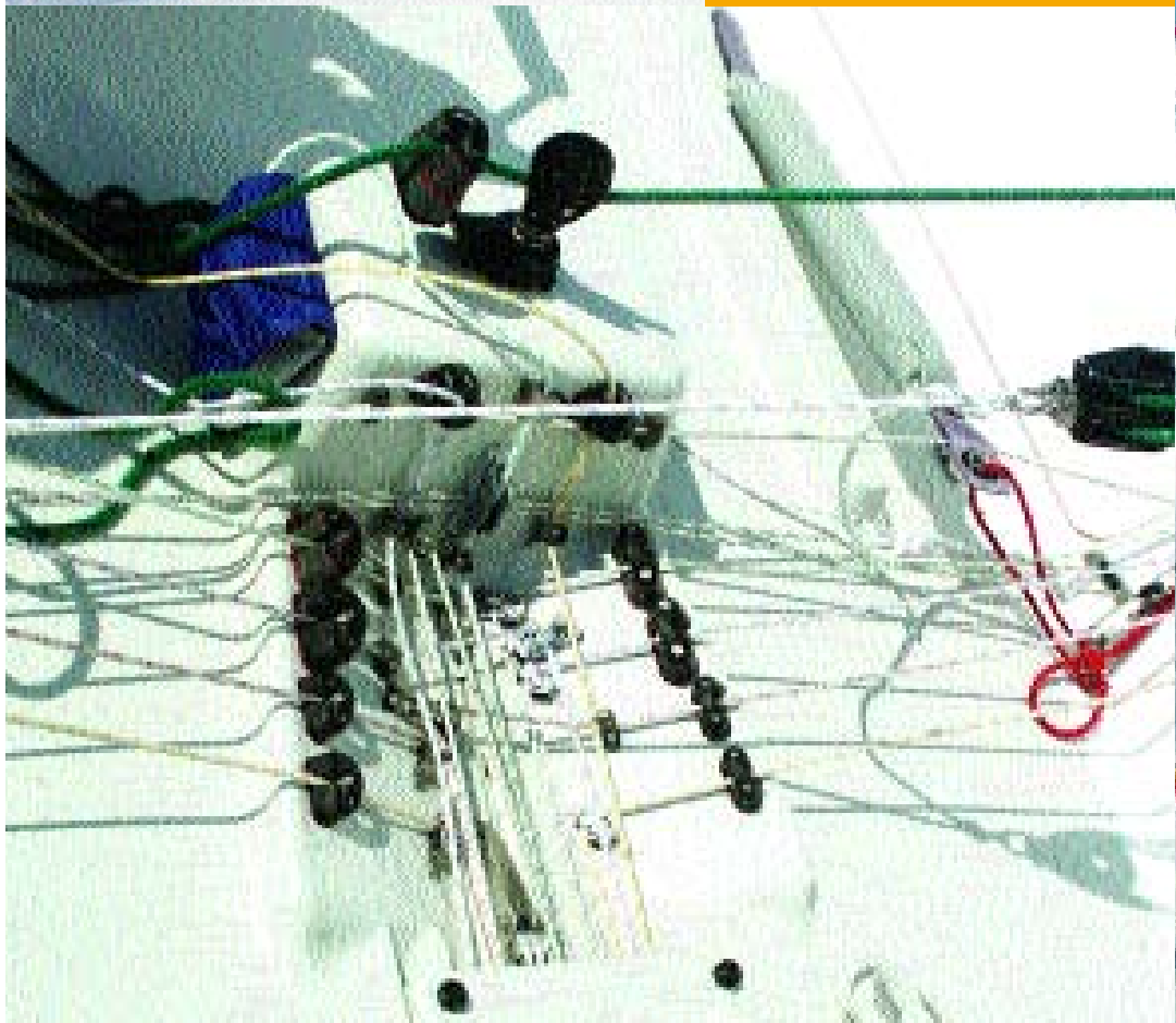
Unten rechts: der Mastfuß. Alles was hier an Leinen ankommt, wird am Kiel vorbei und durch einen Kanal zum Steuermann geführt.
