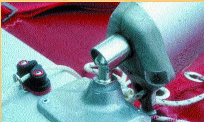
Nun wird der Mast auf den Mastfuß gesetzt und der Mast
