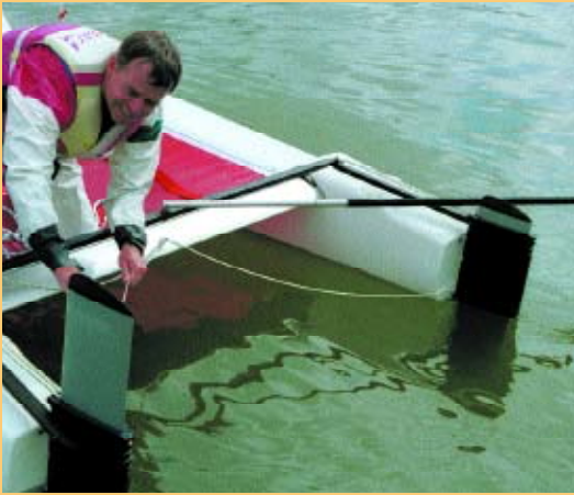
Das patentierte Surfruder kann entweder mit der Reißleine von der tiefen Speedeinstellung in die, durch die Kielabdeckung geschützte, Surfstellung gebracht werden oder bei Grundberührung kippt das Ruderblatt nach hinten und dadurch automatisch in die Surfstellung. Fotos: Isabell Munck
