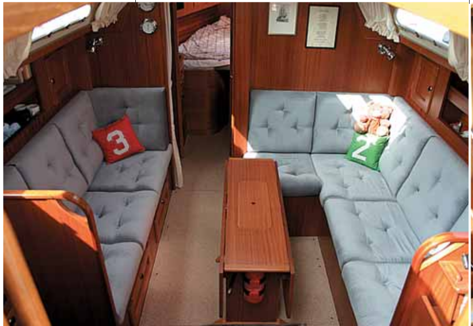
Oben: Der geräumige Salon. Die Maststütze sitzt direkt am Schott und nimmt deswegen kaum Platz weg.
