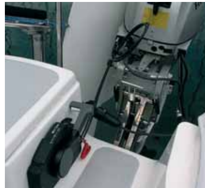
Außenborder, Schaltung griffbereit.
