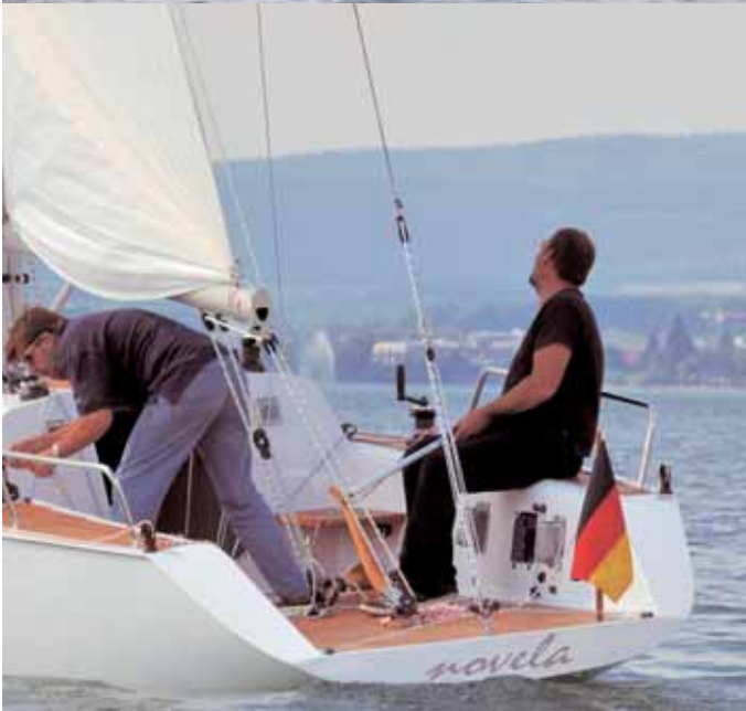
Solide Technik zeichnet die Abraxas aus. Allerdings lässt sich der Großbaum nicht mittschiffs holen, ohne dass das Achterliek zu sehr schließt.
