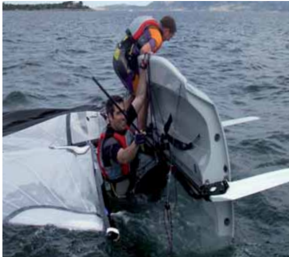
Kentern gehört beim Jollensegeln dazu. Ein gutes Boot taucht dabei relativ weit ein. Zum einen verringert sich dadurch die Neigung, durchzukentern und zum anderen spart es Kraft, wenn das Schwert nicht so hoch über der Wasseroberfläche schwebt.
