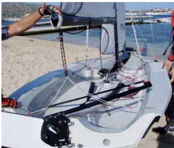
Die Plicht der RS 500 ist ergonomisch gestaltet und die Trimmleinen auf das Wesentliche begrenzt. Die Heckschotführung ist gewöhnungsbedürftig, weil der Ausleger nicht hinten durchgeschwenkt werden kann.
