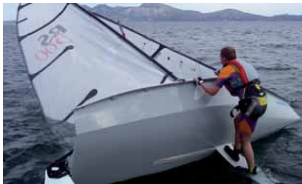
Etwa 70 Kilogramm auf dem Schwert reichen aus, um das Boot aufzurichten. Bei leichteren Seglern sollten beide auf das Schwert stehen.
