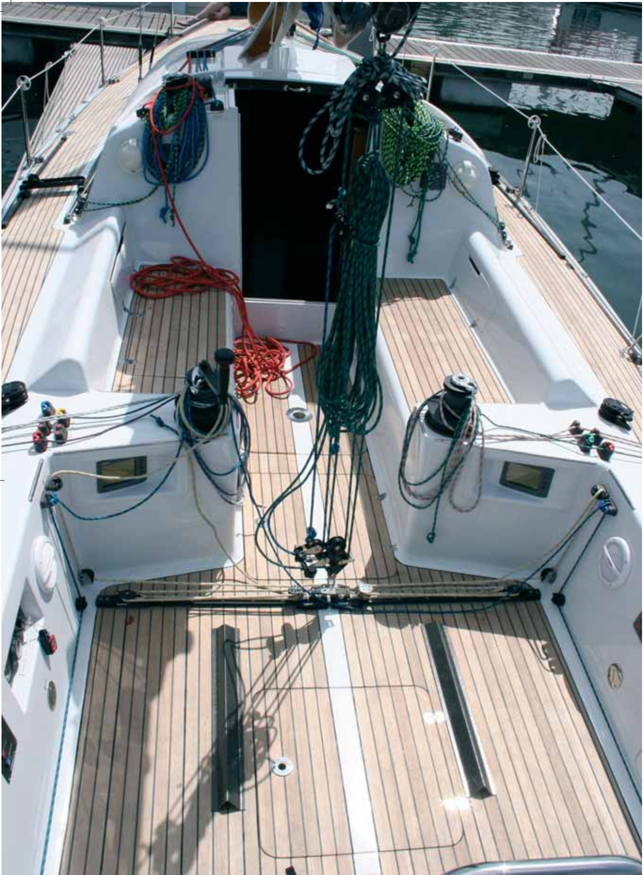
Aufgeräumtes Cockpit. Alle Strecker und Fallen verlaufen nach hinten. Unter der Luke im Cockpitboden ist die Steuerung für die Ballasttanks. Von dort aus kommt man auch an den Ruderquadranten.
