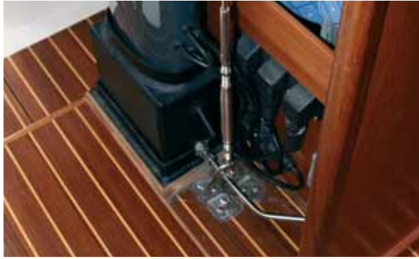
Der Mastfuß enthält einen Hydraulikzylinder, durch welchen das Rigg gespannt und entlastet werden kann.
