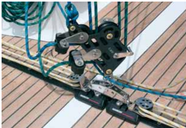
Aufwändiger Großschot-Fußblock mit Grob- und Feinverstellung von Antal.
