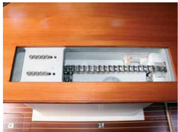
Im Salontisch ist die Mechanik für den Hubkiel untergebracht. Die Kräfte, um die Flosse anzuheben, werden von einer Kette übertragen.
