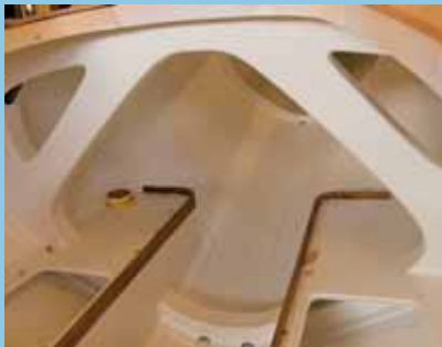
Die geschlossene Mastbrücke fängt den Mastdruck auf.
