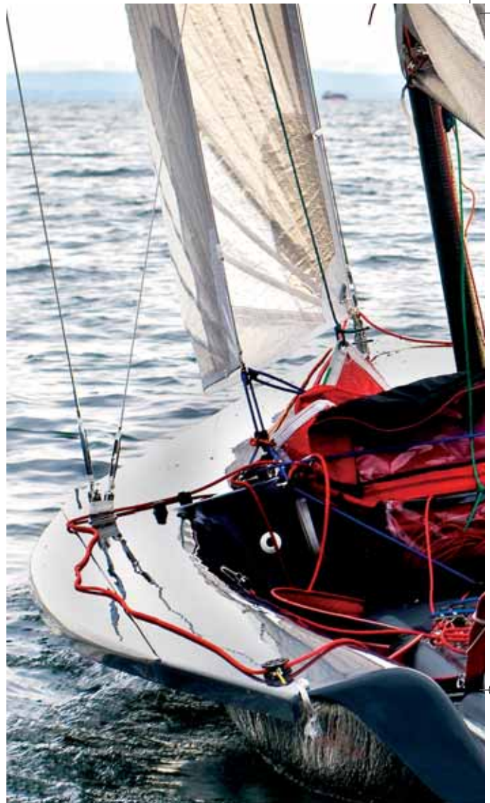
Doppelboden, offenes Heck, runde Tanks und Ausreitgurte. Das Boot sieht eher nach Ausreiten längenverstellbar sein.
