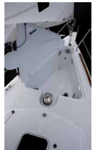
Der Ankerkasten ist in die Deckform integriert. Der Fockroller könnte etwas niedriger sein.
