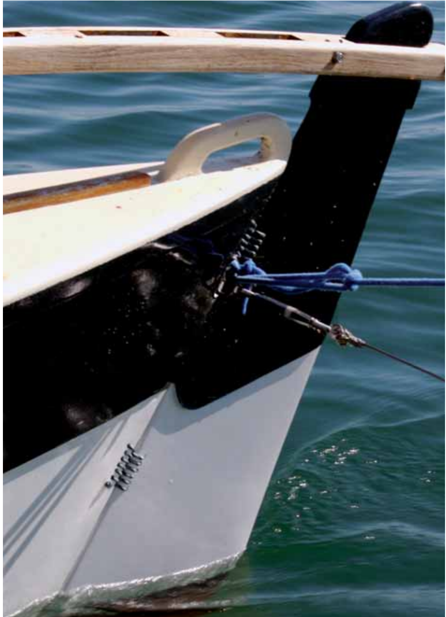
Typisch Wharram und genial noch dazu: Sogar die Ruderbeschläge bestehen aus Tauwerk. Das ist leicht, spiel-frei, preisgünstig und einfach zu reparieren. Die Wandung der Bohrungen muss innen sorgfältig mit Epoxi abgedichtet sein, sonst entsteht eine Quelle für Feuchtigkeit und Fäulnis.
