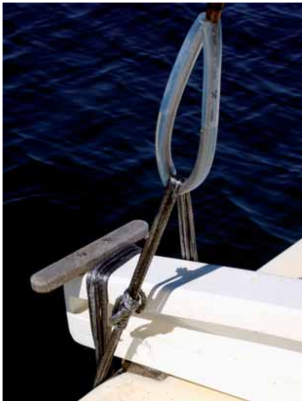
Laschings statt Schrauben. Das gesamte Boot ist mit extrem reißfestem Dyneema-Tauwerk verbunden. Auch die Wanten sind festgelascht.
