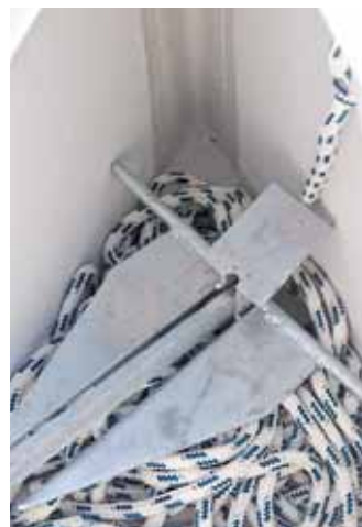
Ankerkasten mit Entwässerung an der tiefsten Stelle.
