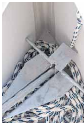
Ankerkasten mit Entwässerung an der tiefsten Stelle.
