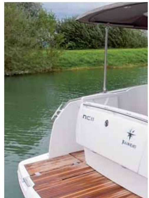
Heckplattform mit verschiebbarer Heckbank und an
