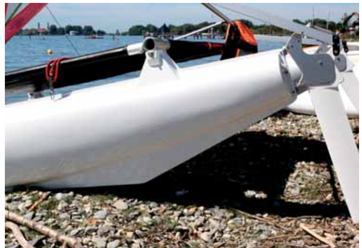
Die Ruderblätter schwenken bei Grundberührung nach oben.
