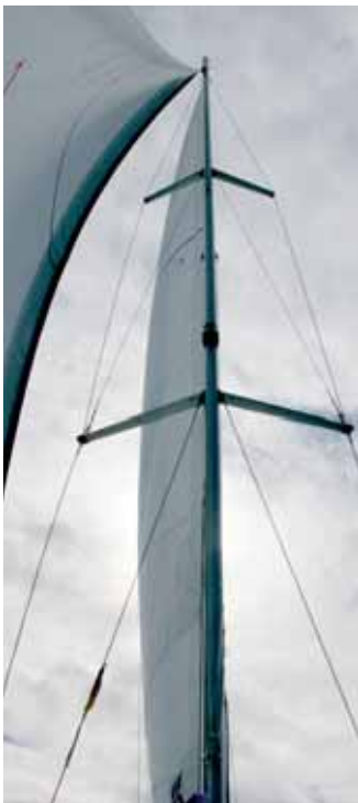
Das Rigg mit zwei Salingpaaren braucht ausreichend Spannung.
