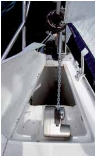
Ankerkasten mit serienmäßiger Winde und Ankergeschirr.
