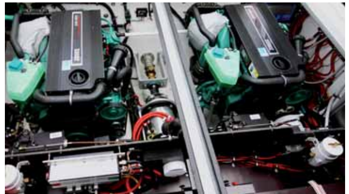
Zwischen den beiden D3-Volvos sitzt der Elektromotor.
