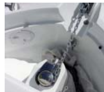
Großer Ankerkasten mit elektrischer Winsch.
